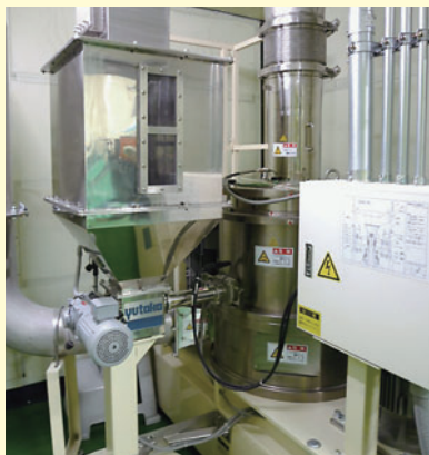
③製粉(粒度測定、水分測定、白度測定)
