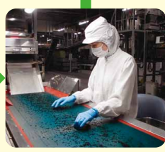
目視選別 機械にて除去漏れを起こした異物を最終的に選別
