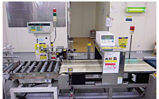
写真⑨ 製造工程 金属探知機・ウェイトチェック
