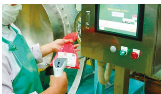
写真④ QRコードを利用した配合事故未然防止システム
