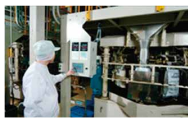
精米自動計量包装機(パッカー)
